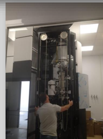
Los nuevos equipamientos en la planta de cultivos marinos y la instalación del microscopio Titán son dos ejemplos relevantes de la mejora de las infraestructuras científicas de la UCA (2019).
